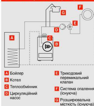
Гідравлічна схема для пакетної пропозиції №2 (з ГВП)
